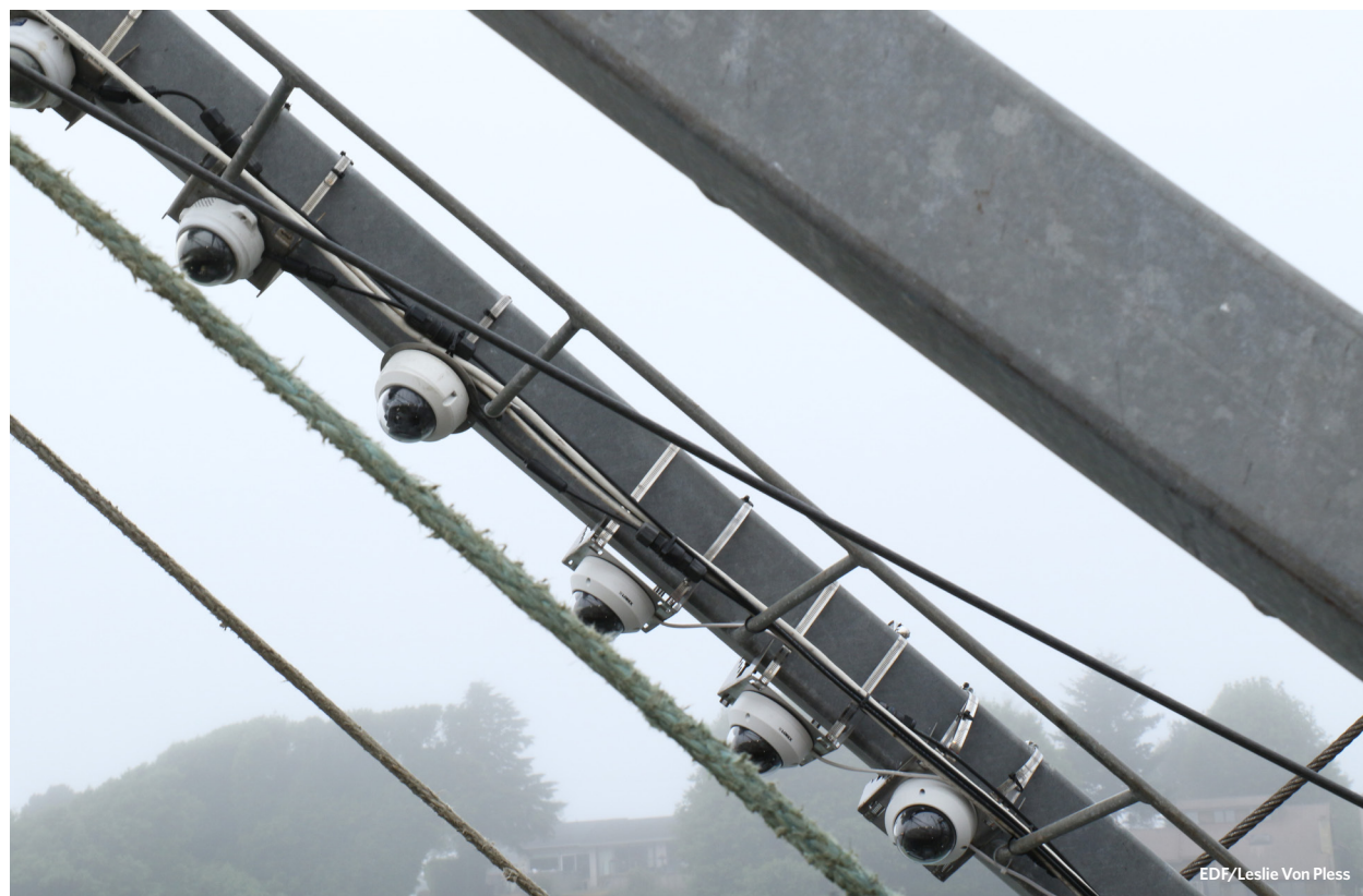
トロール船底部の前方索具に取り付けられた固定レンズカメラ。
