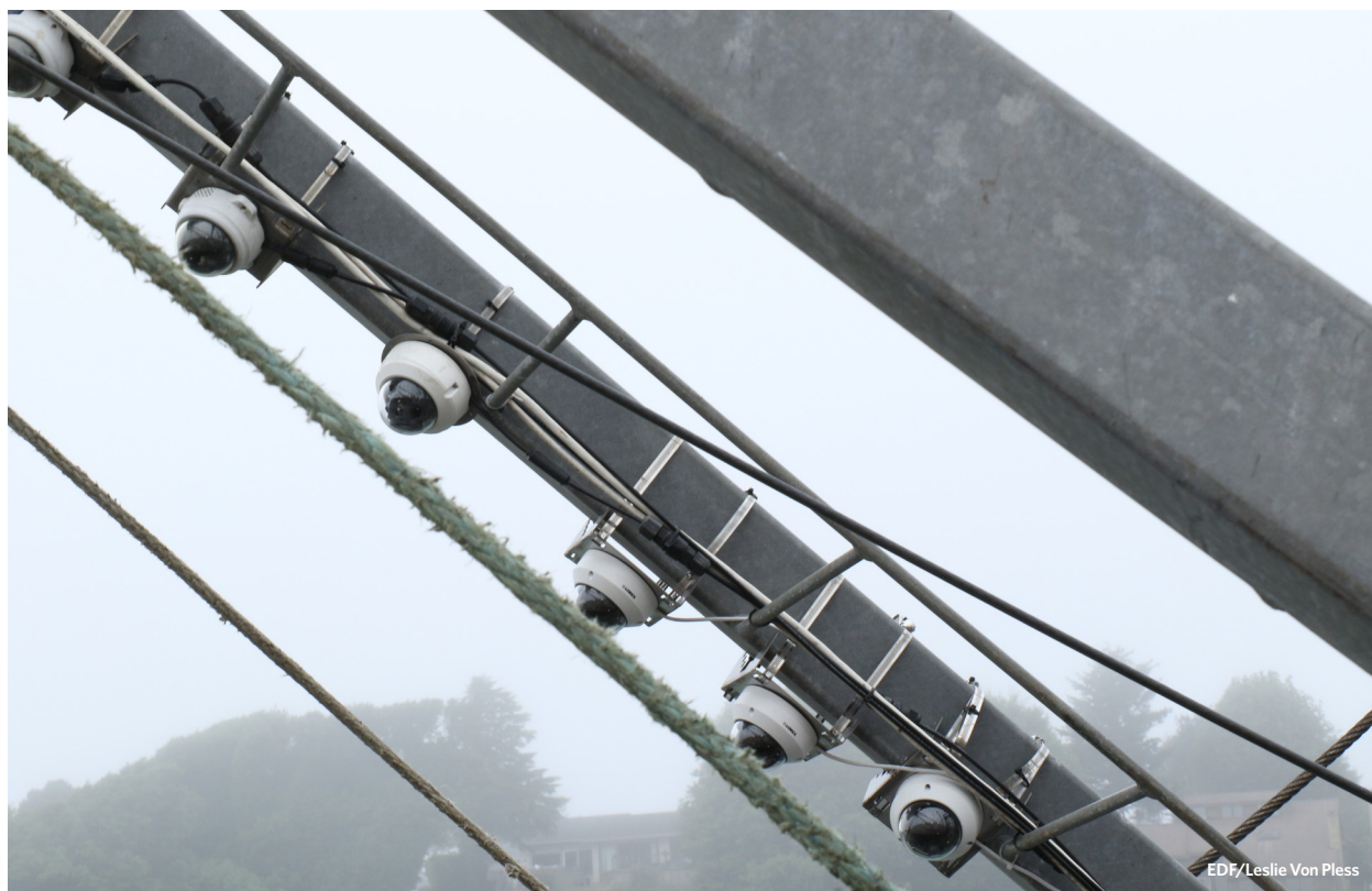
Caméras à focale fixe maintenues au gréement avant d'un chalutier de fond.
