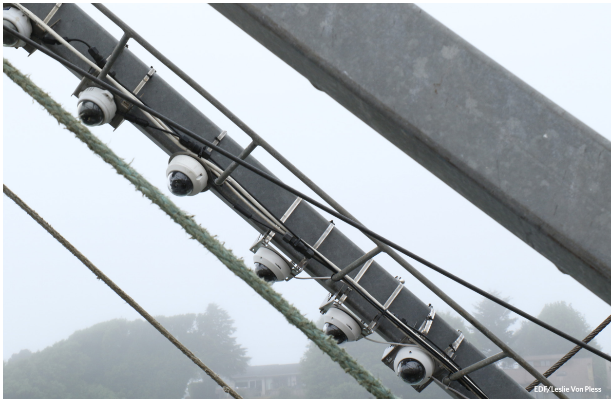
Cámaras de lente fija colocadas en el aparejo delantero de un arrastrero de fondo.
