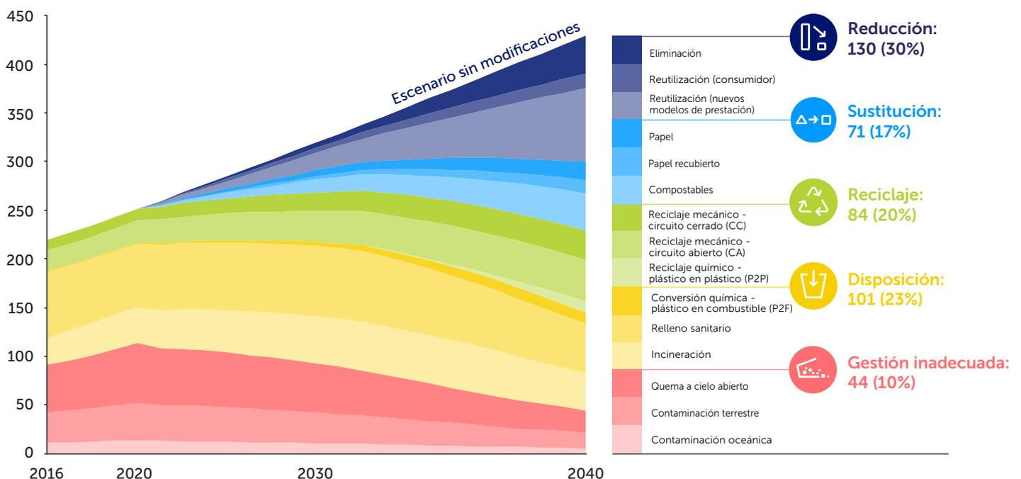
La imagen de las «capas» muestra la porción de las opciones de tratamiento del plástico que ingresa al sistema conforme avanza el tiempo en el Escenario de Cambio de Sistema. Todo plástico que ingresa al sistema tiene un único destino o está dentro de una sola «capa». Los números consideran tanto a los macroplásticos como a los microplásticos.
