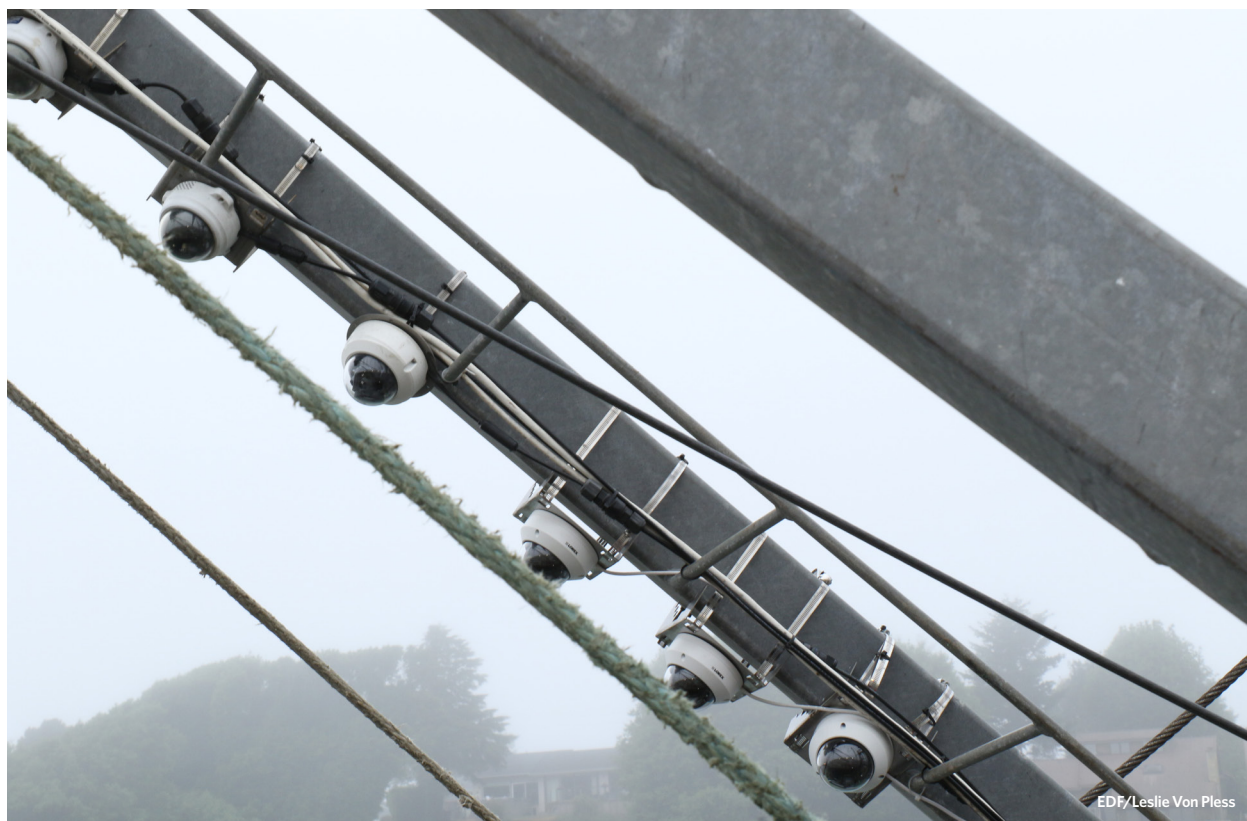
固定镜头摄像机安装在底拖网渔船的前部索具上。
